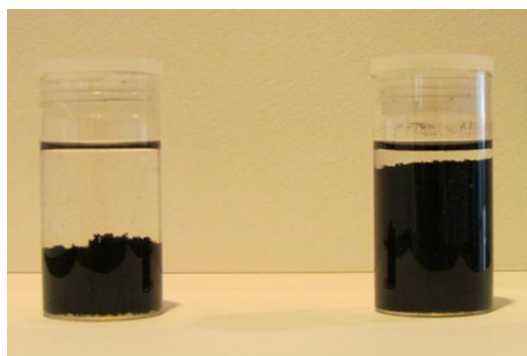
Figura 4.15: Testul de dispersie al materialului pur MWCNT, stânga, și C-f, dreapta, în acetonă, după 7 zile.
